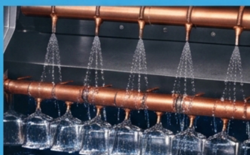
Sistema de prod. por pulverizado de agua
