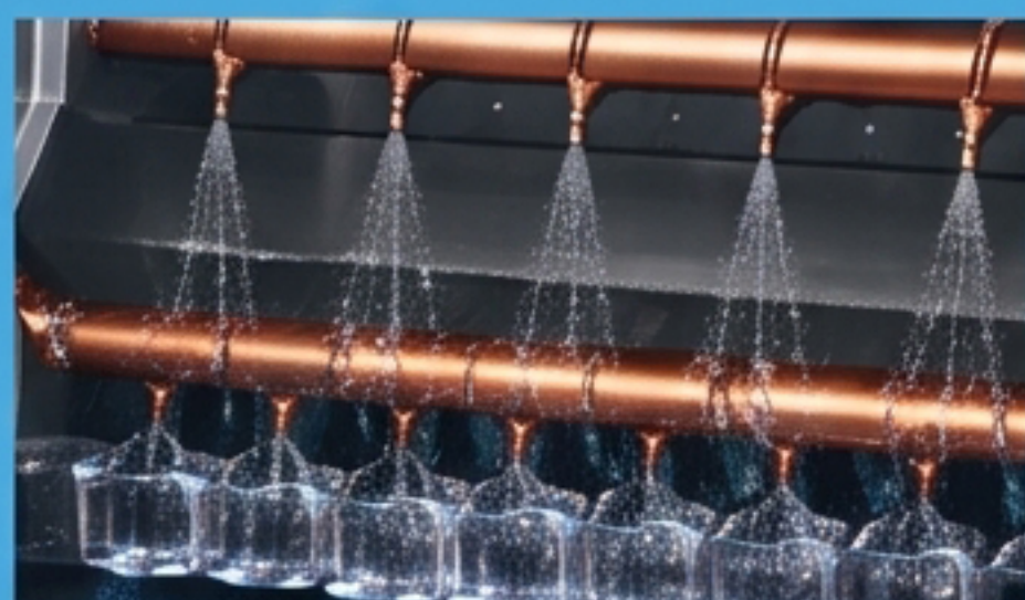
Sistema de prod. por pulverizado de agua
